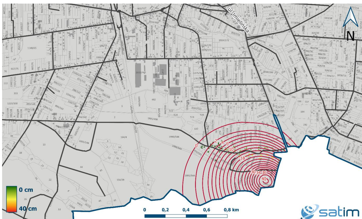
Ryc. 4 - Mapa pionowych przemieszczeń terenu – obniżenia w formie izolinii. Izolinie oddalone od siebie o stałą wartość 2 cm cięcia poziomowego.
