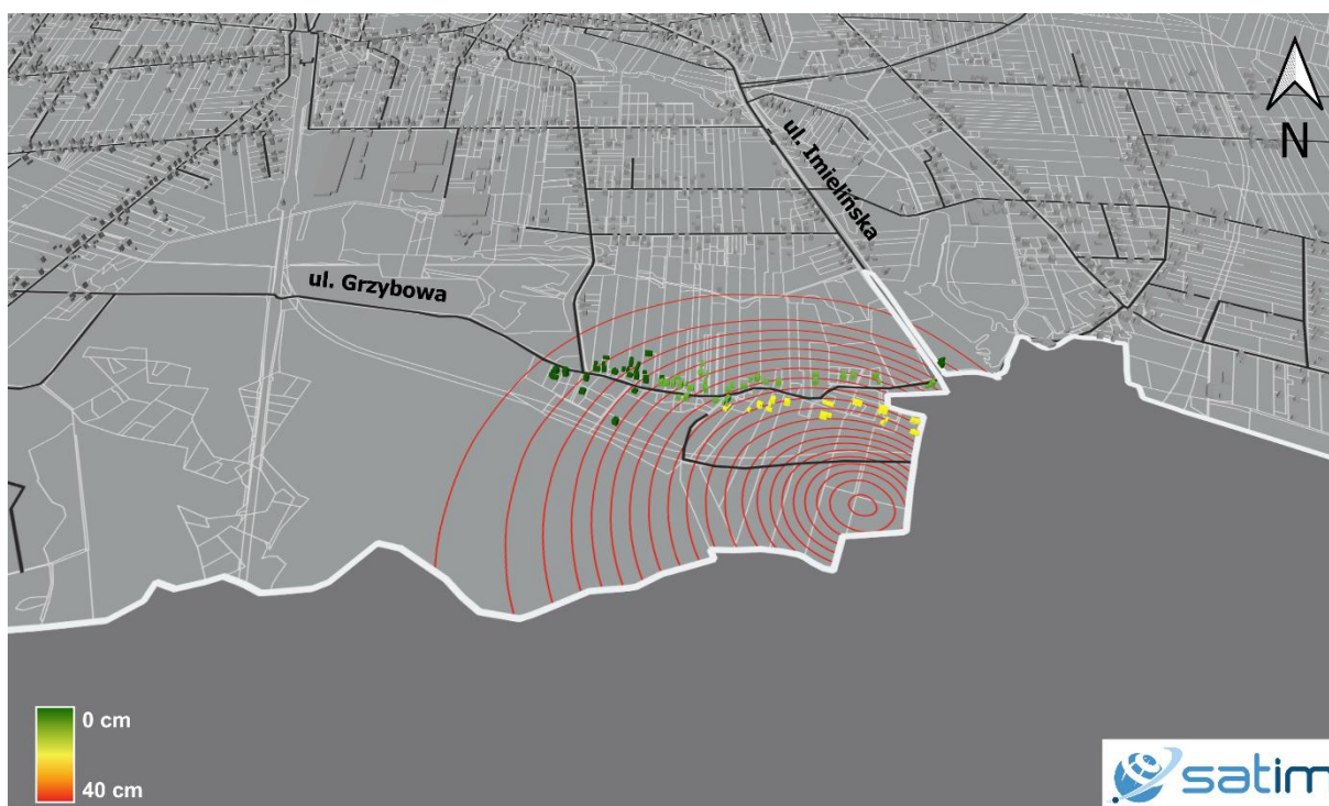
Ryc. 11 – Wizualizacja budynków i ulic. Kolorami oznaczone zostały budynki ze względu na wielkość osiadania terenu pod nimi w II półroczu 2025 r. Izolinie osiadań oddalone od siebie o stałą wartość 2 cm cięcia poziomowego.
