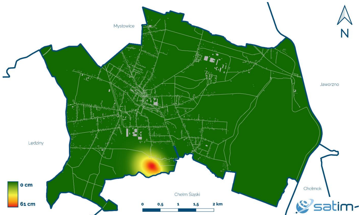
Ryc. 1 – Mapa pionowych przemieszczeń terenu. Maksymalne osiadania terenu, jakie wystąpiły w I półroczu 2024 roku to ok. 61 cm.
