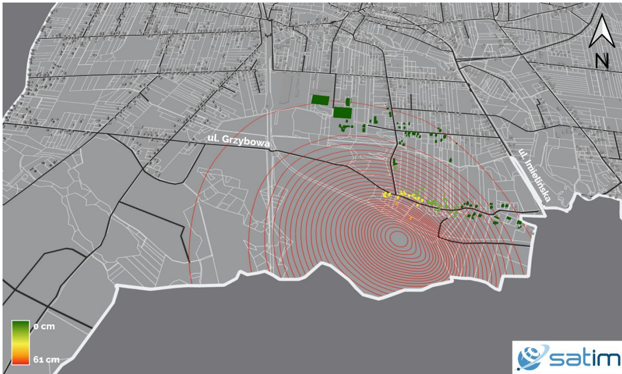
Ryc. 10 – Wizualizacja budynków i ulic. Kolorami oznaczone zostały budynki ze względu na wielkość osiadania terenu pod nimi w I półroczu 2024 r. Izolinie osiadań oddalone od siebie o stałą wartość 2 cm cięcia poziomicowego.
