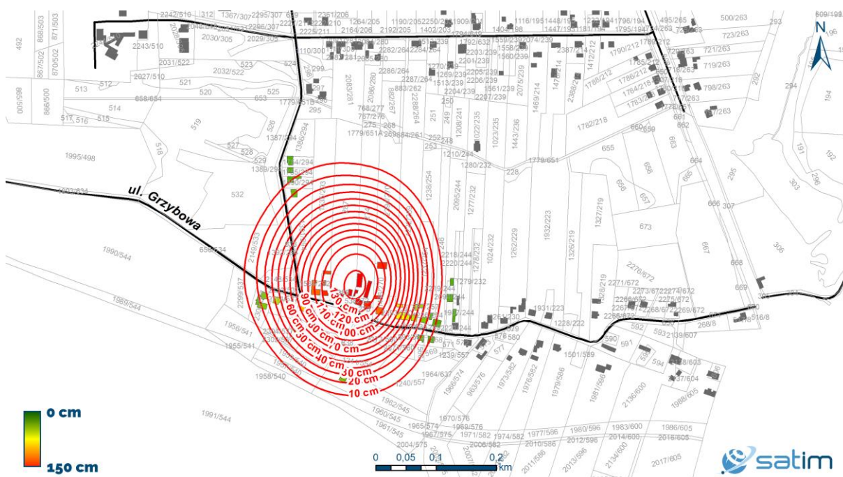
Ryc. 4 - Mapa pionowych przemieszczeń terenu – obniżenia w formie izolinii. Izolinie oddalone od siebie o stałą wartość 10 cm cięcia poziomowego. Kolorami oznaczone zostały budynki ze względu na wielkość osiadania terenu pod nimi.
