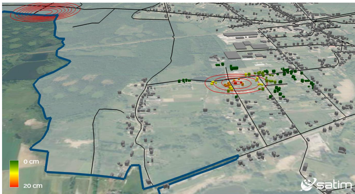
Ryc. 9 – Wizualizacja budynków na niecce obniżeniowej. Kolorami oznaczone zostały budynki ze względu na wielkość osiadania terenu pod nimi w IV kwartale 2021 r. Izolinie osiadań oddalone od siebie o stałą wartość 5 cm cięcia poziomowego
