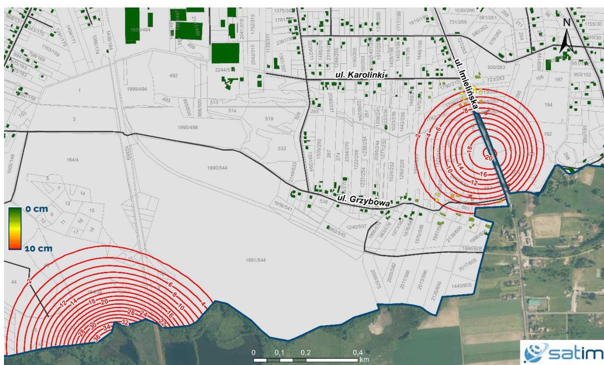
Ryc. 4 - Mapa pionowych przemieszczeń terenu – obniżenia w formie izolinii. Izolinie oddalone od siebie o stałą wartość 2 cm cięcia poziomowego. W IV kwartale 2020 r. 27 budynków znajdowało się na zagrożonym obszarze.
