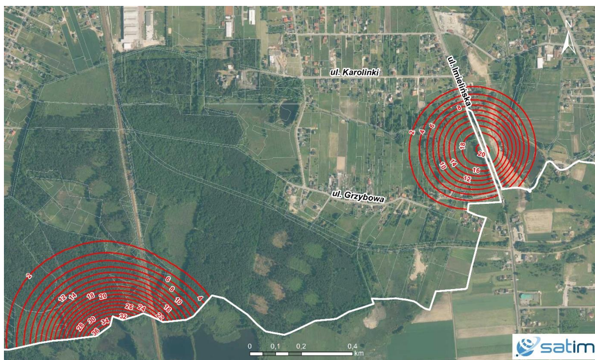
Ryc. 3 - Mapa pionowych przemieszczeń terenu – obniżenia w formie izolinii. Izolinie oddalone od siebie o stałą wartość 2 cm cięcia poziomowego.
