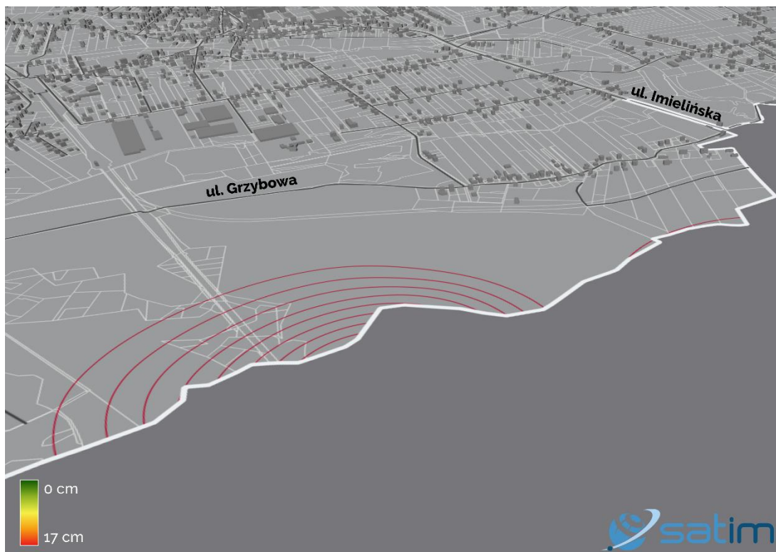
Ryc. 10 – Wizualizacja budynków i ulic. Kolorami oznaczone zostały budynki ze względu na wielkość osiadania terenu pod nimi w II kwartale 2022 r. Izolinie osiadań oddalone od siebie o stałą wartość 2 cm cięcia poziomowego
