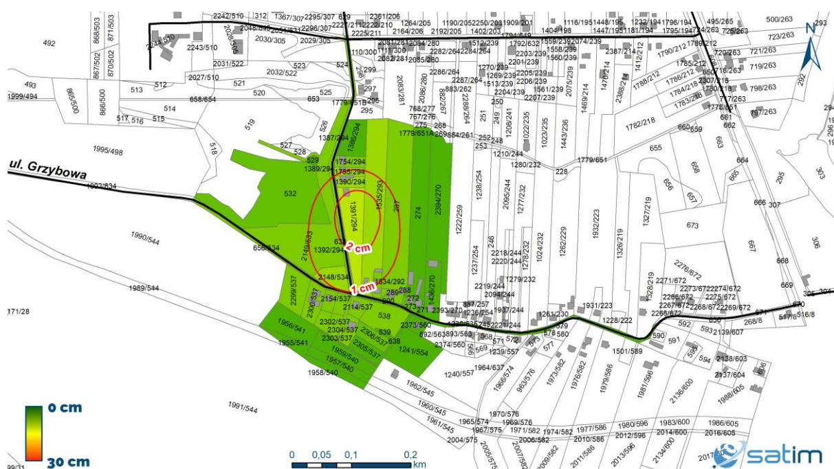
Ryc. 6 - Mapa działek ewidencyjnych. Kolorami oznaczone zostały działki ze względu na średnią wielkość osiadania terenu w ich obrębie. Izolinie osiadań oddalone od siebie o stałą wartość 1 cm cięcia poziomowego
