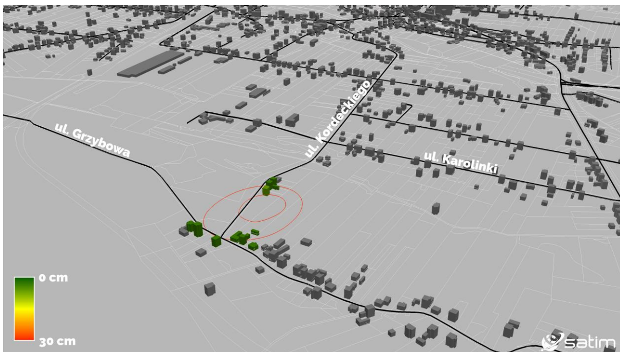
Ryc. 10 – Wizualizacja budynków i ulic. Kolorami oznaczone zostały budynki ze względu na wielkość osiadania terenu pod nimi w II kwartale 2019r. Izolinie osiadań oddalone od siebie o stałą wartość 1 cm cięcia poziomowego
