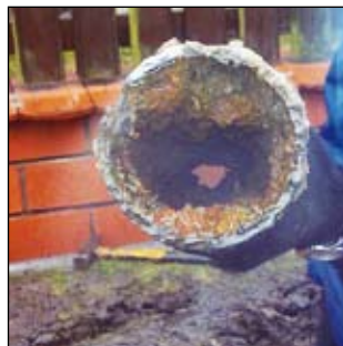
Najwięcej poszkodowanych było na ul. Ściegiennego. Poniżej stalowa rura, na której osadziła się gruba warstwa kamienia.
